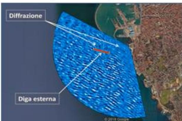
Ricostruzione propagazione d'onda 3D
